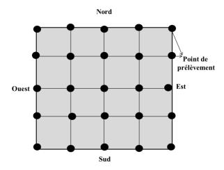
Fig.2: Dispositif de prélèvement des échantillons des sols Source: SEYNI BODO, 2018
